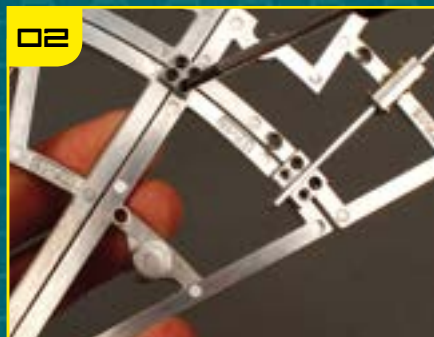
02 Зафиксируйте угол рамы, закрутив винт в накладку с четырьмя отверстиями.
