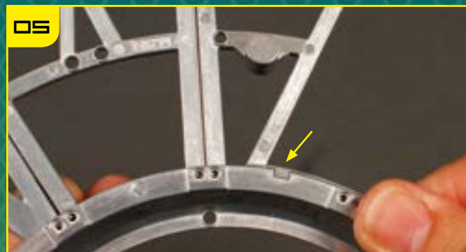
05 Убедитесь, что выступ на раме TF-16 совпадает с соответствующим вырезом на ребре кольца TF-9.
