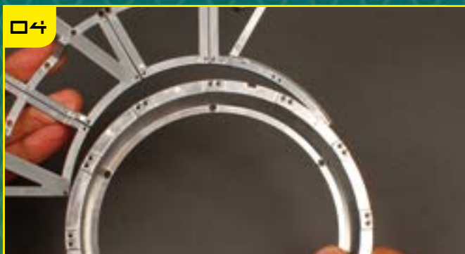
04 Разместите кольцо турели TF-9 в центре собранной конструкции.
